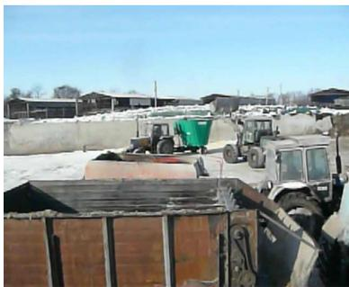
Рисунок 3 – Один погрузчик обслуживает три кормораздатчика (ГП ОХ «Кутузовка»); при этом возможна загрузка «на потоке»
