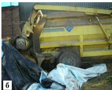
Рисунок 1 – Самоходный (ТОВ АФ «Горняк», а) и прицепной (ЧАФ «Билый Стик», б) погрузчик - смеситель - раздатчик кормов
