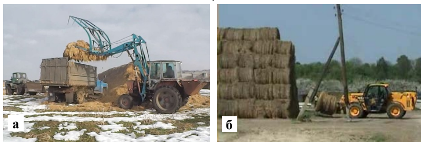
Рисунок 1 – Погрузка подстилочной соломы: рассыпной двумя погрузчиками совместно с перевозчиком-разгрузчиком ("а") и тюкованной универсальным погрузчиком-перевозчиком-разгрузчиком с рабочим органом «вильчатый захват» («б»)
