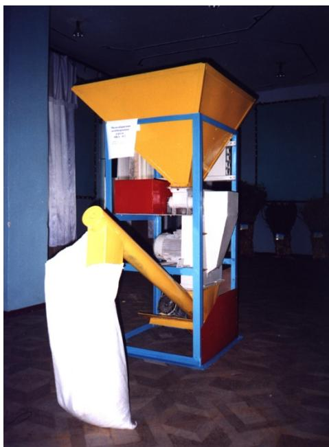
Рисунок 1 – Малогабаритный комбикормовый агрегат
