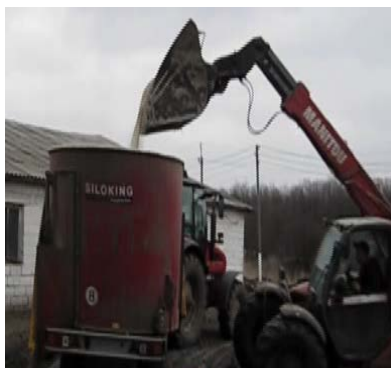
Рисунок 3 – Удачная конструкция рабочего органа погрузчика позволяет без проблем загружать корма даже в высокий бункер
