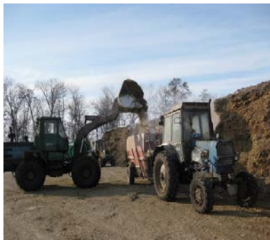
Рисунок 5 – Погрузчик Т-156 осуществляет загрузку с перемещением от корма к кормораздатчику
