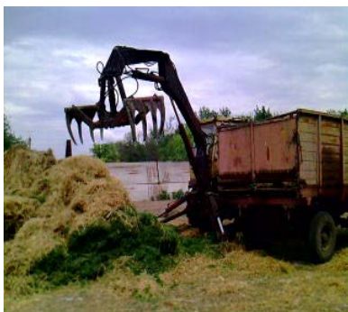
Рисунок 4 – Погрузчик экскаваторного типа осуществляет погрузку только в стационарном положении с выдвинутыми опорами
