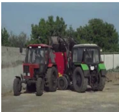
Рисунок 2 – Несоответствие высоты бункера кормораздатчика максимальной высоте подъема и конструкции рабочего органа у погрузчика приводит к чрезмерному сближению машин
